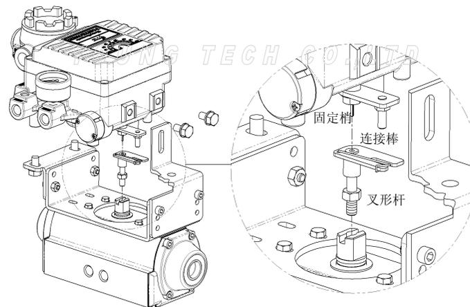
图：YT-1000R主轴上的固定槽和叉形反馈杆孔的连接
