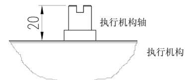
图：执行机构轴的高度(当H=20mm时)
